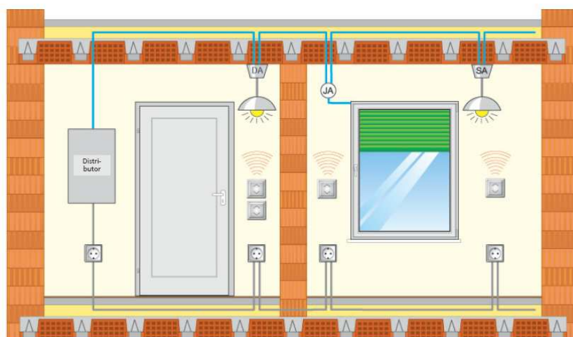
Kuva 2.3.3 Toimilaitteille viedään sähköt normaalisti ja ohjaustieto langattomasti
